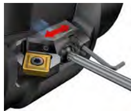
СС – осевая регулировка, обработка фаски
